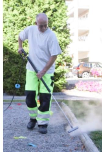
**En utilisant un désherbeur à eau chaude, 4 interventions par an sont suffisantes. Le réglage de température (98-99 °C), essentiel dans la réussite et l'uniformité du désherbage, se fait automatiquement après l'allumage.**
